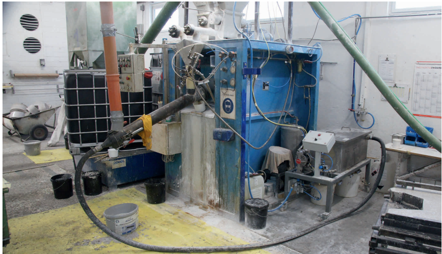
Bild 1. Win-win-Situation: Die Schneckenmischer dieser Polymerbeton-Anlage werden heute mit einem Spezialreiniger gespült. Er spart Kosten und schützt die Mitarbeiter. Im Vergleich zu vorher wird außerdem nur noch einen Bruchteil an Chemie benötigt. © Färber & Schmid
